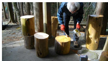
ひび割れ防止剤を塗る
