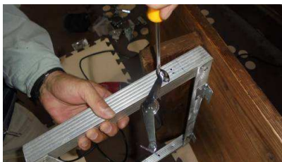
食事台の止め金具をステー金具に取替作業
