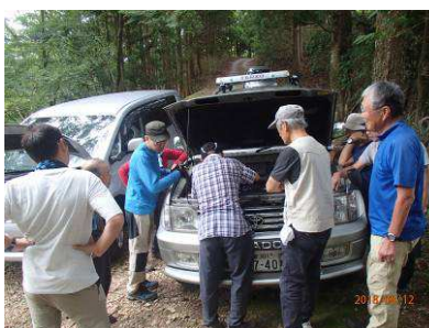
バッテリー接続線補修
