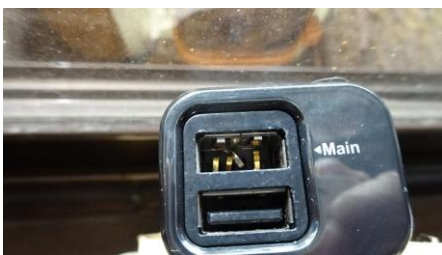
端子が壊れた充電器
